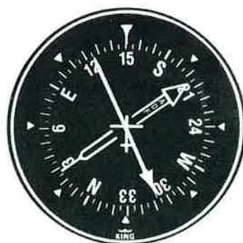
Fig. nº 91 - RMI comum sem sistema de seleção de leitura; agulha larga verde representa o ADF e agulha fina amarela representa o VOR.
