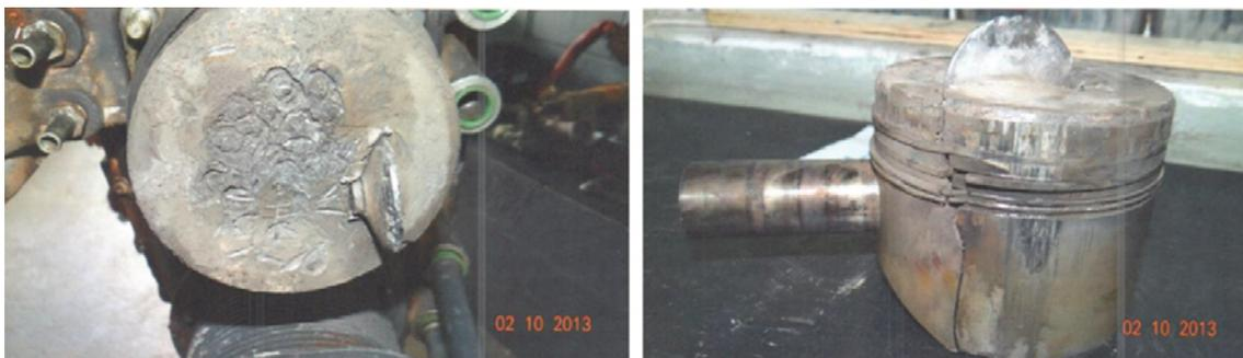
Figura 3. Fotos do pistão submetido a uma falha catastrófica resultante da ruptura da válvula de exaustão.
