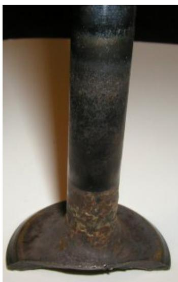
Figura 5: Válvula fraturada na face. Imagem fornecida pela ERMAER.
