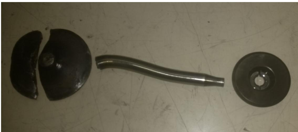
Figura 2: Válvula de admissão fraturada. Imagem fornecida pela ERMAER.
