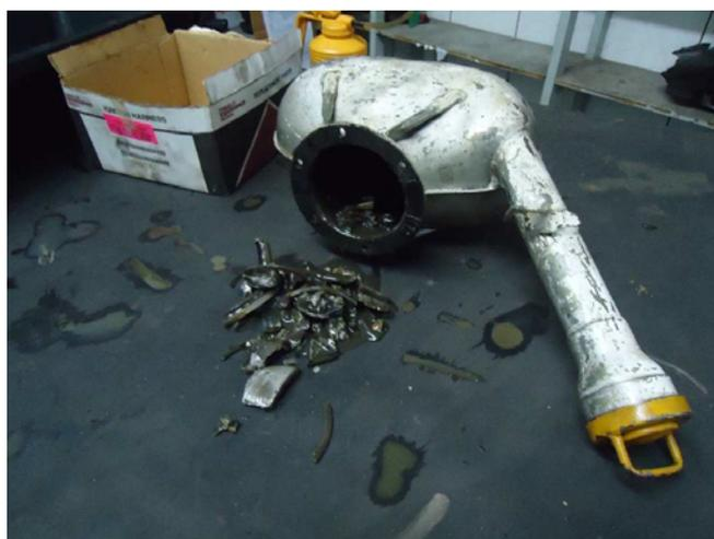
Figura 6. Fragmentos da válvula de exaustão e do pistão encontrados dentro do cárter após falha no cilindro em decorrência do travamento da válvula de exaustão devido à execução da troca de óleo em período superior ao recomendado.
