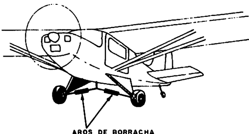
Trem de Pouso Articulado com Amortecedores de Borracha
