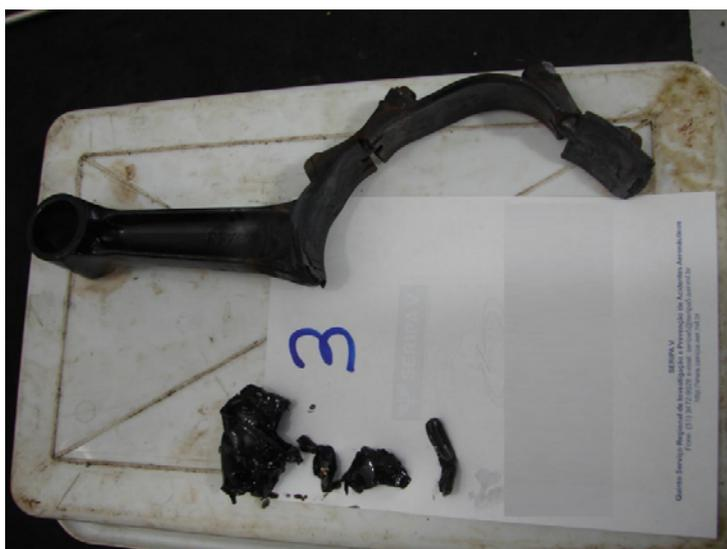
**Figura 2:** Biela rompida após superaquecimento do conjunto.
