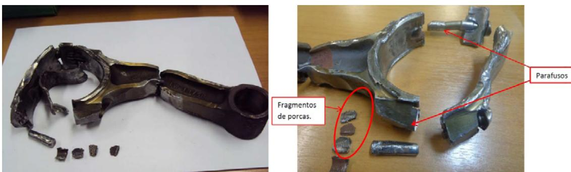
**Figura 4:** Conjunto da biela rompido, com causa provável de afrouxamento da porca do conjunto.
