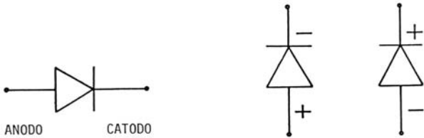
Figura 4-17 Símbolo e polarização dos diodos
