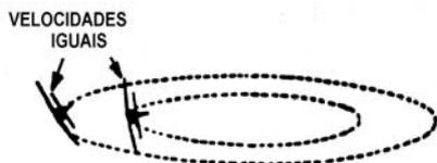
Figura 2-74 Inclinação diferente com velocidades iguais
