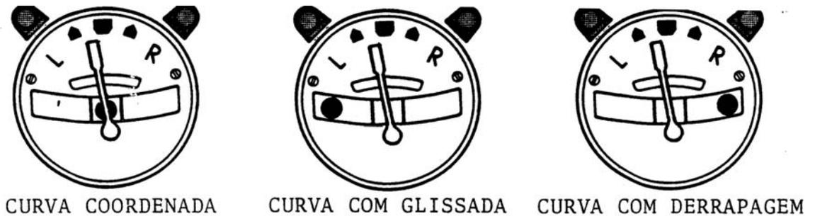
Figura 2-85 Indicações de um inclinômetro em situações distintas de vôo.
