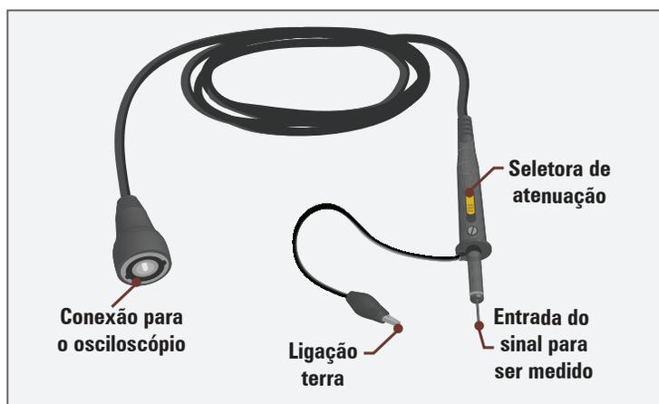
Figura 203 - Ponteiras de prova de osciloscópio com chave seletora de atenuação
