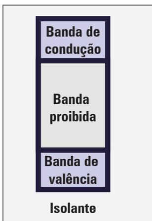
Figura 47.A - Material isolante
