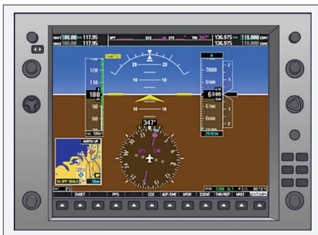
Figura 221 - Tela primária de voo com o EADI na parte superior e o EHSI na inferior
