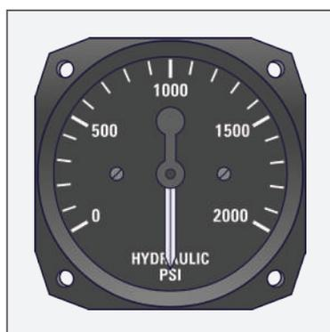
Figura 50 - Manômetro analógico do sistema hidráulico
