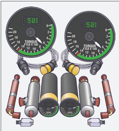
Figura 255 - Indicadores de torque, transmissores e conexões
