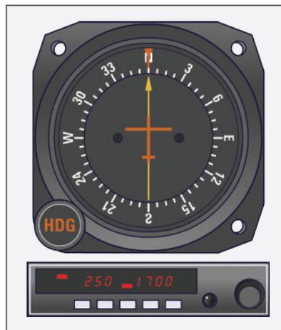
Figura 20 - Indicador de ADF e seu receptor
