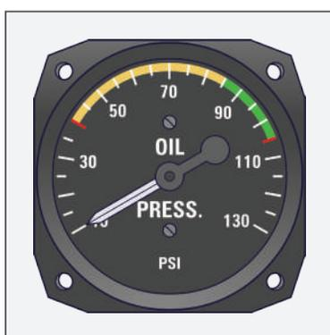
Figura 39 - Manômetro analógico de óleo do motor
