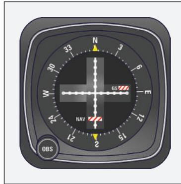
Figura 217 - Indicação do *glide slope* e do localizador ILS no diretor de voo analógico
