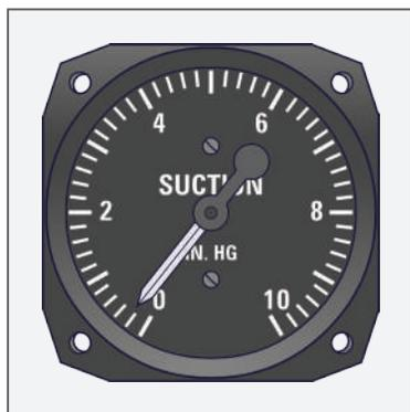
Figura 54 - Manômetro analógico de sucção
