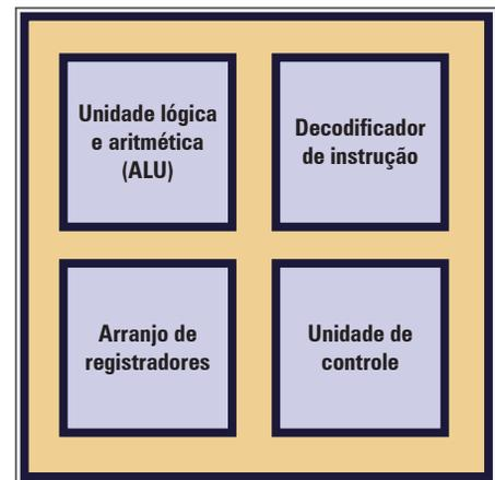
Figura 165 - Arquitetura básica de um microprocessador
