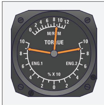
Figura 248 - Indicador de torque de helicóptero bimotor
