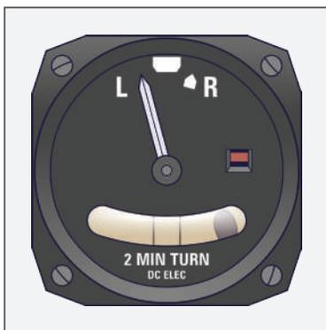
Figura 193.A - Indicador de curva e de inclinação
