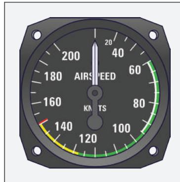
Figura 81 - Indicador de velocidade analógico
