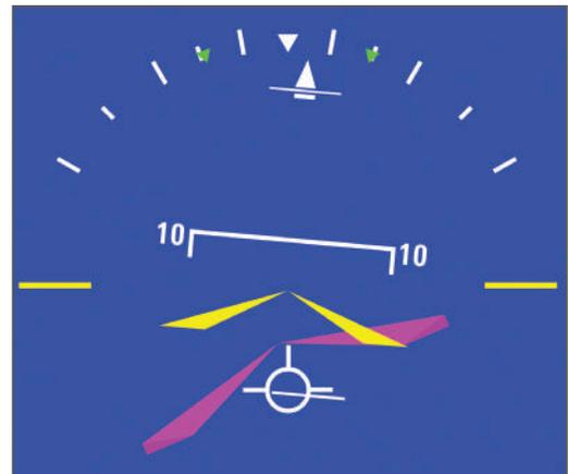
Figura 213 - Indicação da barra do diretor de voo (amarela) no indicador de atitude digital
