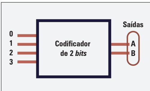
Figura 71.A - Codificador de dois bits
