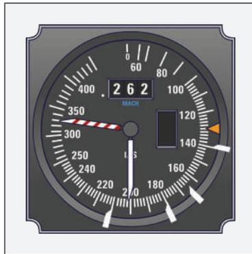
Figura 89 - Velocímetro com indicação de velocidade *mach*
