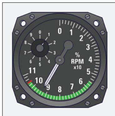
Figura 98 - Tacômetro analógico de motor a turbina
