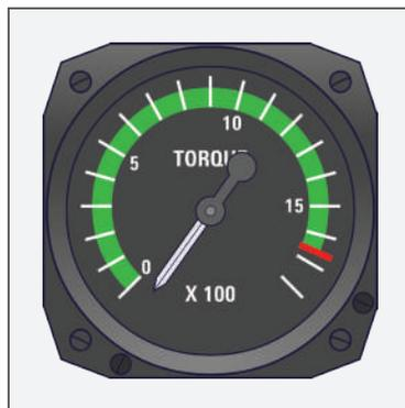
Figura 249 - Indicador de torque do motor analógico
