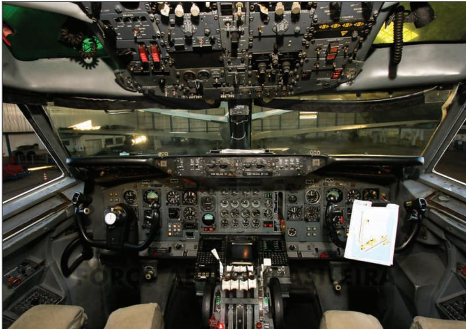
Figura 2 - Cabine com instrumentos analógicos
