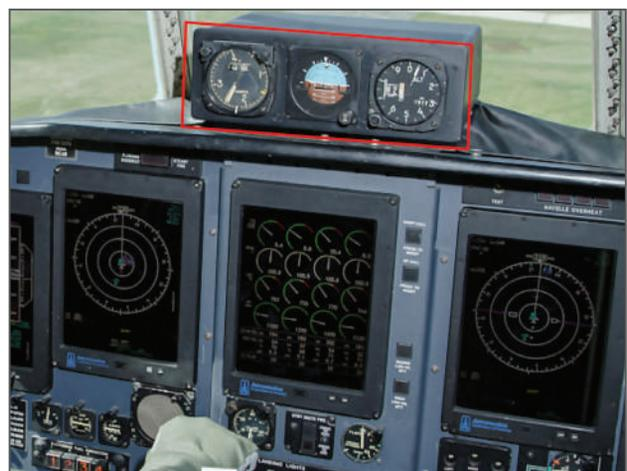
Figura 12 - Painel com monitores e três instrumentos analógicos de reserva
