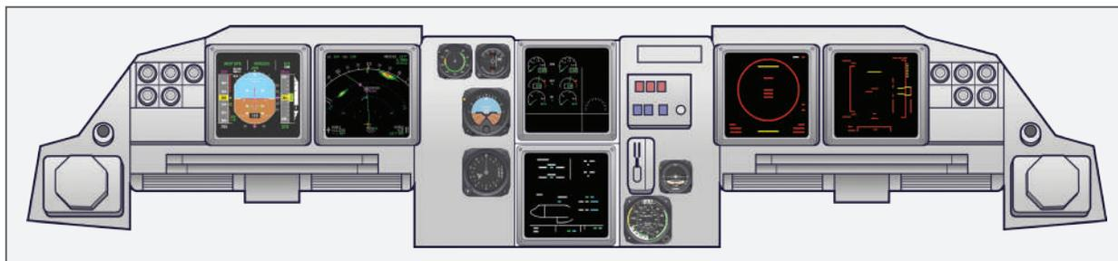
Figura 228 - Telas do ECAM no painel (monitores centrais)
