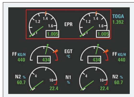
Figura 47 - Indicação de pressão diferencial do motor em painel digital
