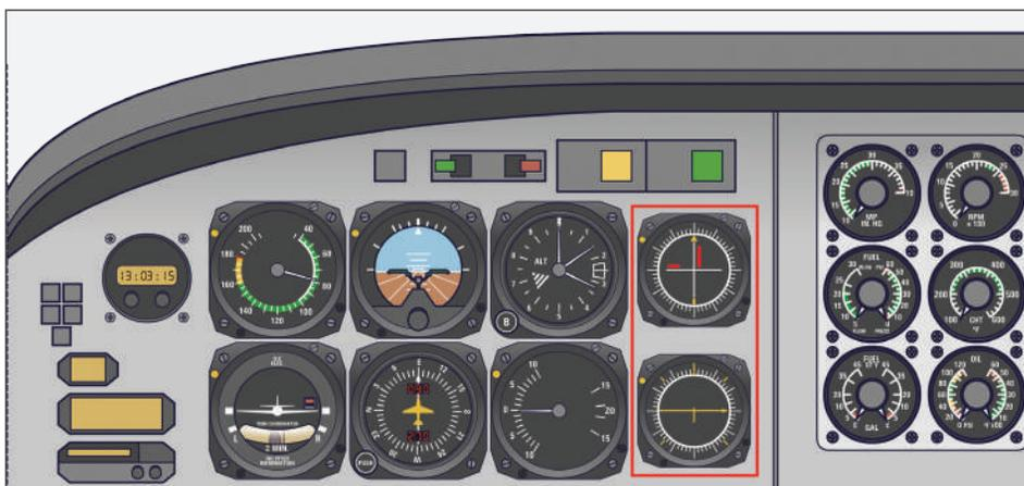
Figura 16 - Painel com instrumentos analógicos de navegação em destaque
