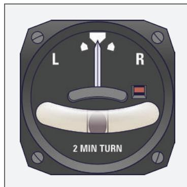
Figura 194 - Indicador de curva e de derrapagem com calibragem de dois minutos
