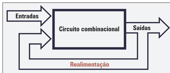
Figura 83 - Diagrama esquemático do circuito combinacional
