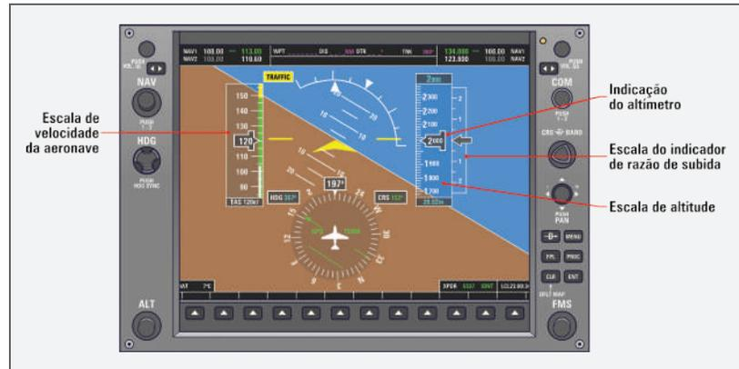
Figura 73 - Indicação de altitude (escala à esquerda do HSI) no PFD
