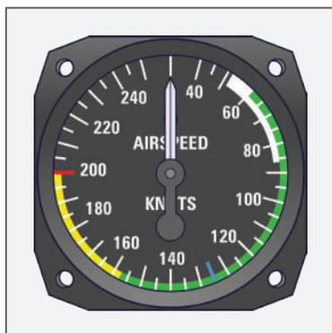
Figura 272 - Marcações no velocímetro
