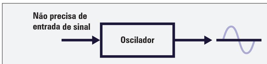
Figura 125.B - Oscilador eletrônico sem recepção de sinal de entrada
