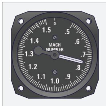
Figura 87 - Maquímetro analógico
