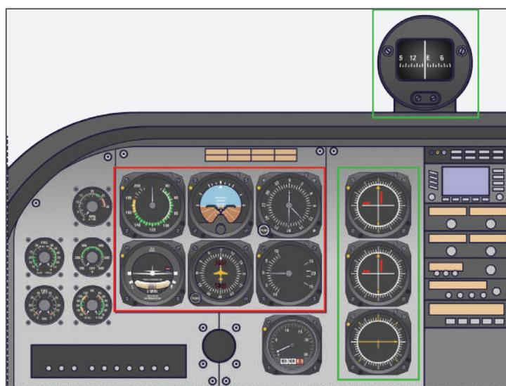
Figura 22 - Seis instrumentos analógicos básicos de voo (vermelho) e de navegação (verde)
