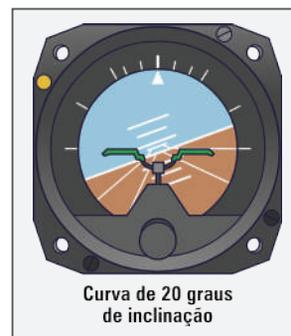
Figura 9 - Horizonte artificial com inclinação de 20° para a direita
