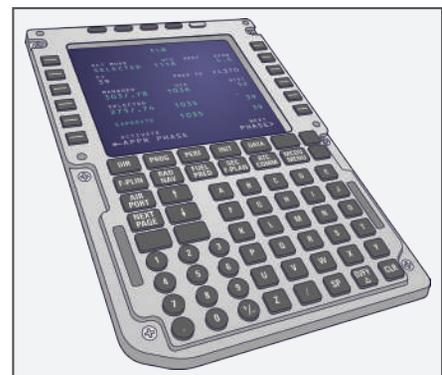
Figura 35 - Tela do FMS usada em aeronaves comerciais
