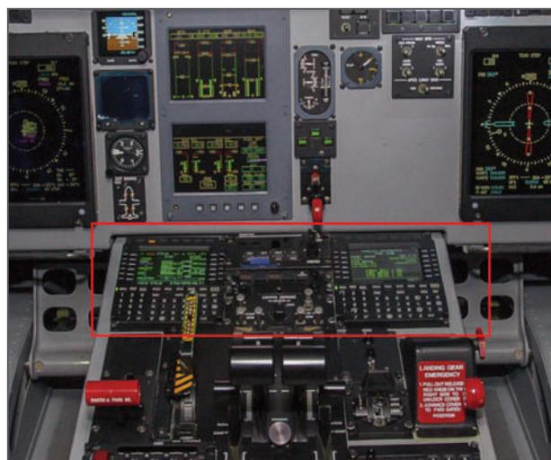
Figura 238 - Dois controles de FMS no pedestal da cabine
