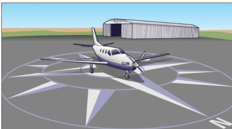
Figura 283 - Avião sobre a rosa dos ventos para a compensação de bússola
