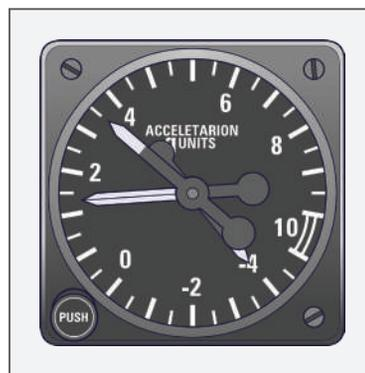
Figura 107 - Acelerômetro com indicação do limite de aceleração positiva e negativa
