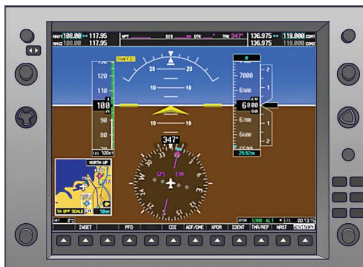
Figura 23 - Instrumentos primários de voo em tela digital
