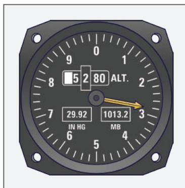
Figura 72 - Altímetro com contador numérico
