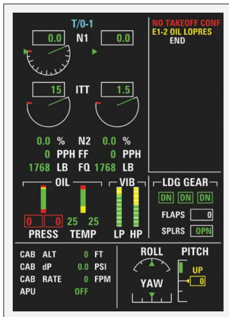
Figura 273 - Indicação de limites de operação com auxílio do código de cores
