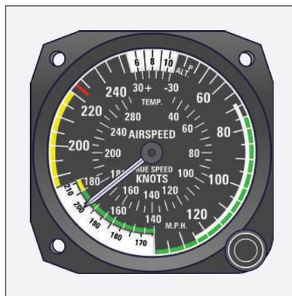
Figura 83 - Velocímetro com botão de ajuste para velocidade real
