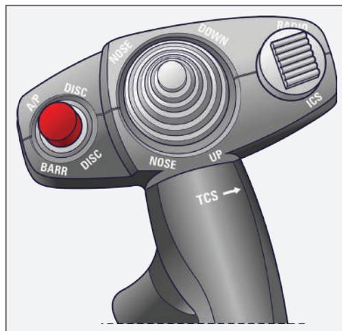
Figura 284 - Interruptor de desacoplamento do piloto automático
