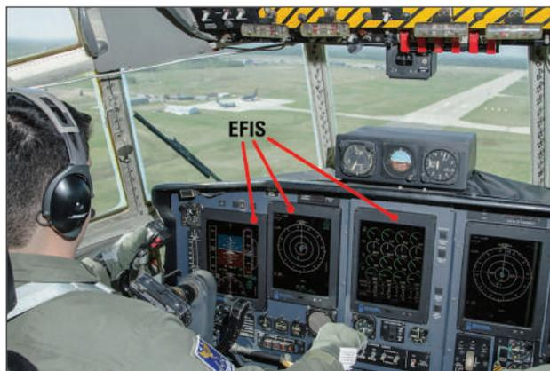
Figura 27 - Sistema EFIS na cabine de um avião comercial de passageiros
