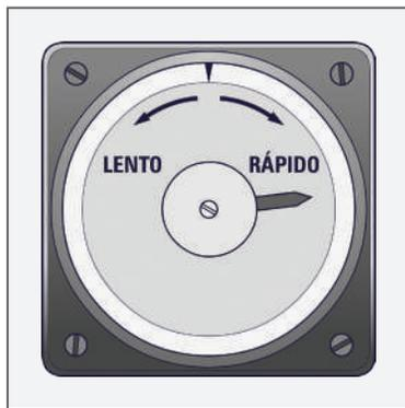
Figura 106 - Sincrocópio
