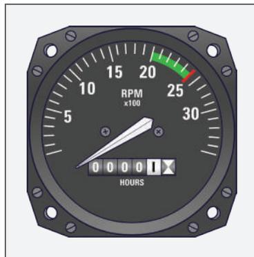
Figura 97 - Tacômetro analógico de motor alternativo
