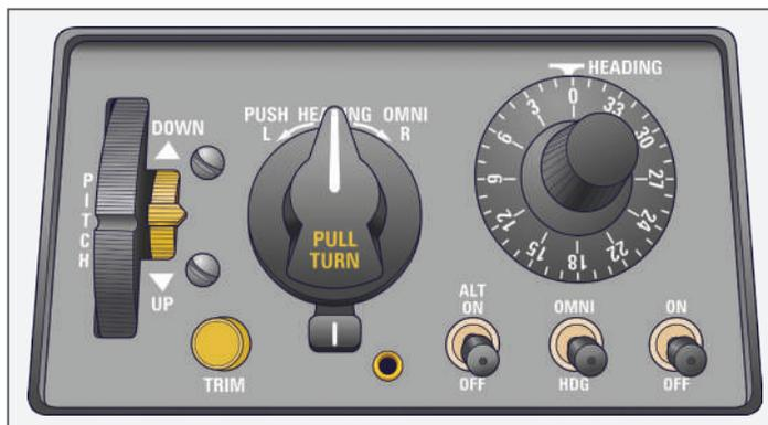
Figura 285 - Controlador analógico simples do piloto automático
