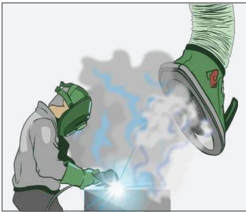
Figura 58.A - Braço exaustor de solda
