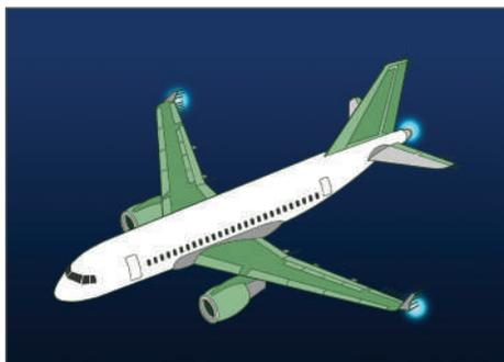
Figura 87.C - Anticolisão na ponta das asas e no estabilizador horizontal
