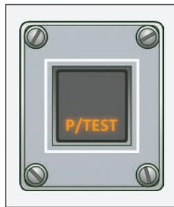
Figura 71.A - Interruptor com iluminação aplicação típica
