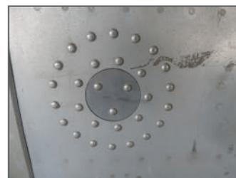
Figura 7.C - Reparo de revestimento em formato circular temporário
