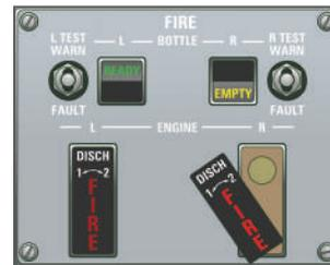
Figura 41 - Painel de comando com motor direito acionado
