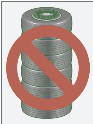
Figura 60.B - Forma incorreta de armazenar pneus
