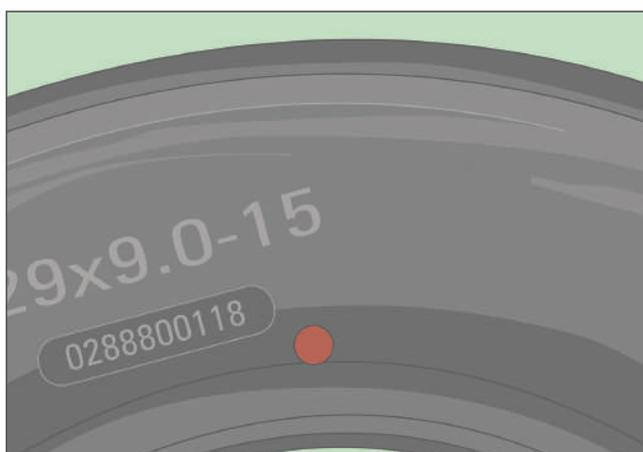
Figura 71 - Marca vermelha de balanceamento
