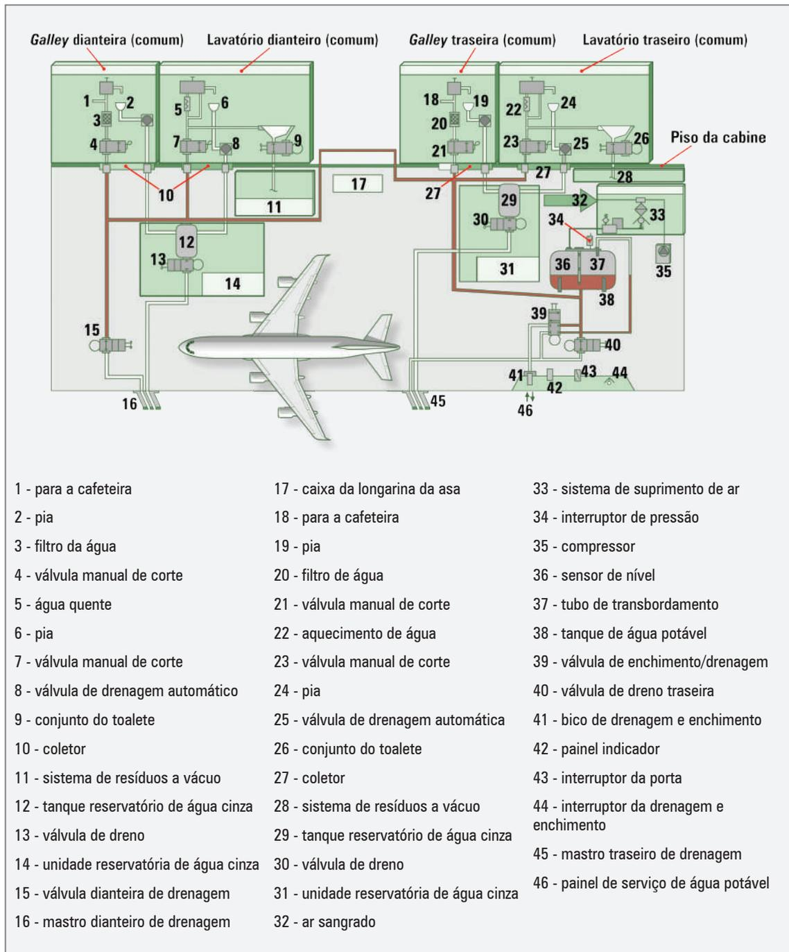
Figura 1 - Sistema de água potável da aeronave modelo E190
