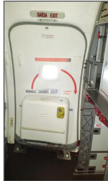
Figura 9.C - Porta traseira de saída da aeronave modelo B737-800
