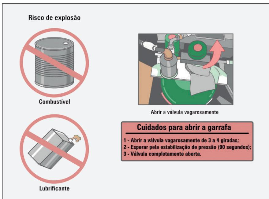
Figura 109 - Cuidados a serem tomados na remoção e instalação dos cilindros de oxigênio
