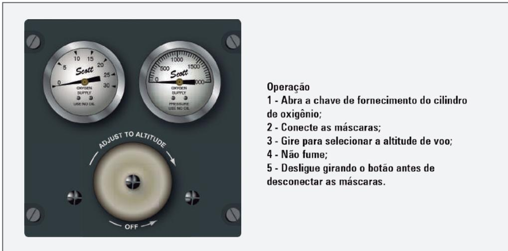
Figura 92 - Painel de controle do regulador manual de oxigênio de fluxo contínuo
