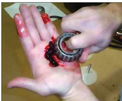
Figura 87.A - Lubrificação do rolamento
