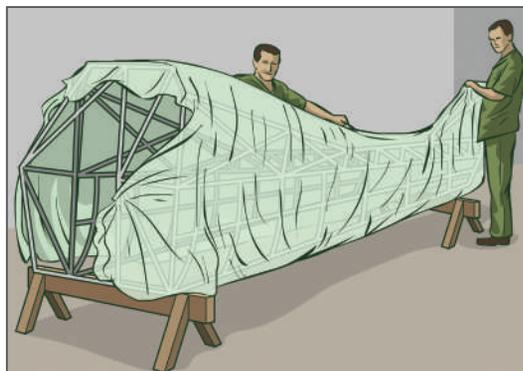
Figura 12 - Aplicação do revestimento pelo método do envelope
