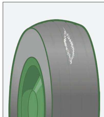
Figura 78.B - Pneu usado além do limite
