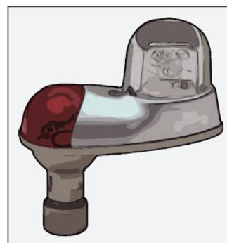
Figura 89 - Anticolisão tipo estroboscópica de ponta de asa
