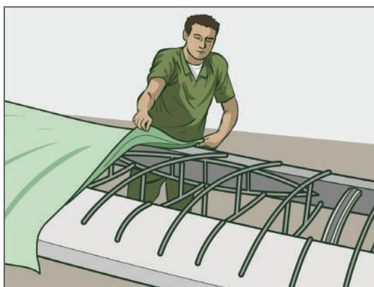
Figura 11 - Aplicação do revestimento pelo método do cobertor
