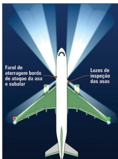
Figura 93 - Luzes de aterragem e luzes de inspeção das asas
