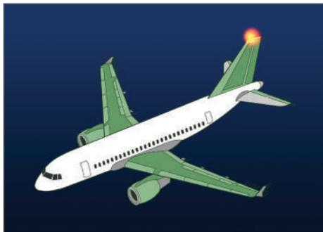
Figura 87.A - Anticolisão no estabilizador vertical
