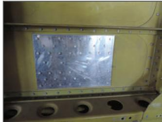
Figura 6.B - Remendo retangular na parte interna do reparo
