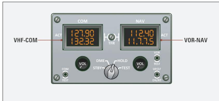
Figura 10 - Exemplo de uma unidade de controle de equipamento conjunto de VHF/VOR
