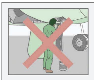
Figura 106.C - Parar o abastecimento do sistema hidráulico
