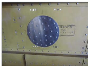
Figura 7.B - Remendo circular na parte interna da aeronave
