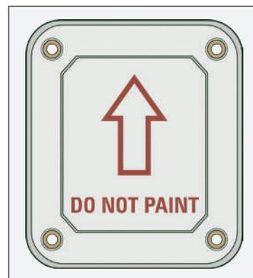
Figura 17.B - Antena do sistema radioaltímetro
