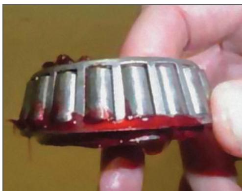
Figura 87.B - Rolamento após ser lubrificado
