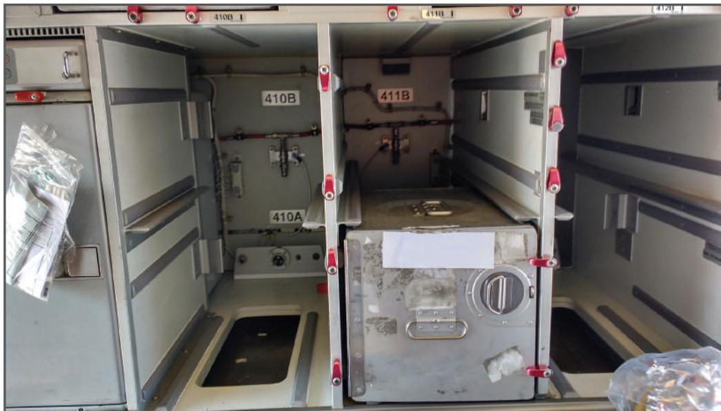
Figura 12 - Compartimento da *galley* mostrando ao fundo o conector e a fiação da aeronave *turbofan* comercial modelo B737-800
