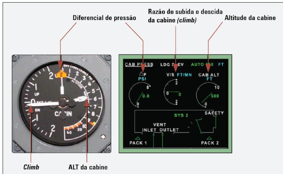
Figura 86 - Instrumento de pressurização da cabine
