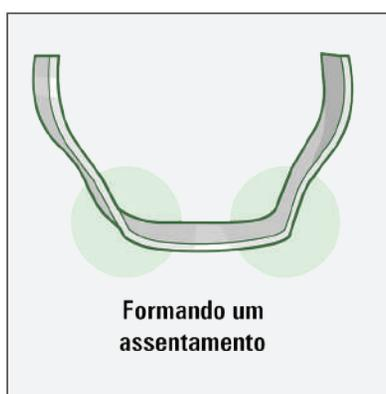
Figura 58.B - Inspeção do formato de assentamento da câmara de ar
