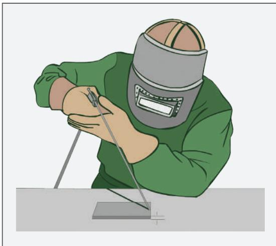
Figura 29 - Inclinação do eletrodo
