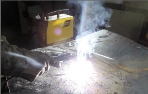
Figura 57 - Gases e fumos sendo gerados na soldagem
