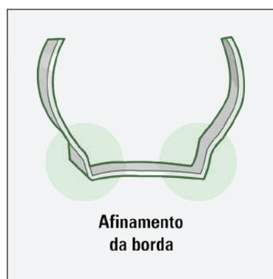
Figura 58.C - Inspeção do afinamento de borda da câmara de ar
