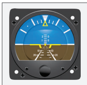
Figura 38.A - Indicador de atitude comum acionado por sucção mostrando a aeronave em voo nivelado
