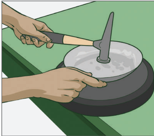
Figura 31 - Golpeamento sobre um saco de areia
