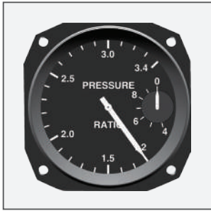
Figura 7.A - Um indicador EPR analógico de um motor a turbina
