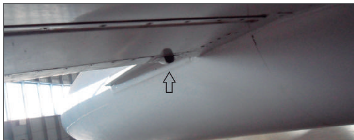
Figura 17 - Exemplo de suspiro do sistema de degelo dos bordos de ataque
