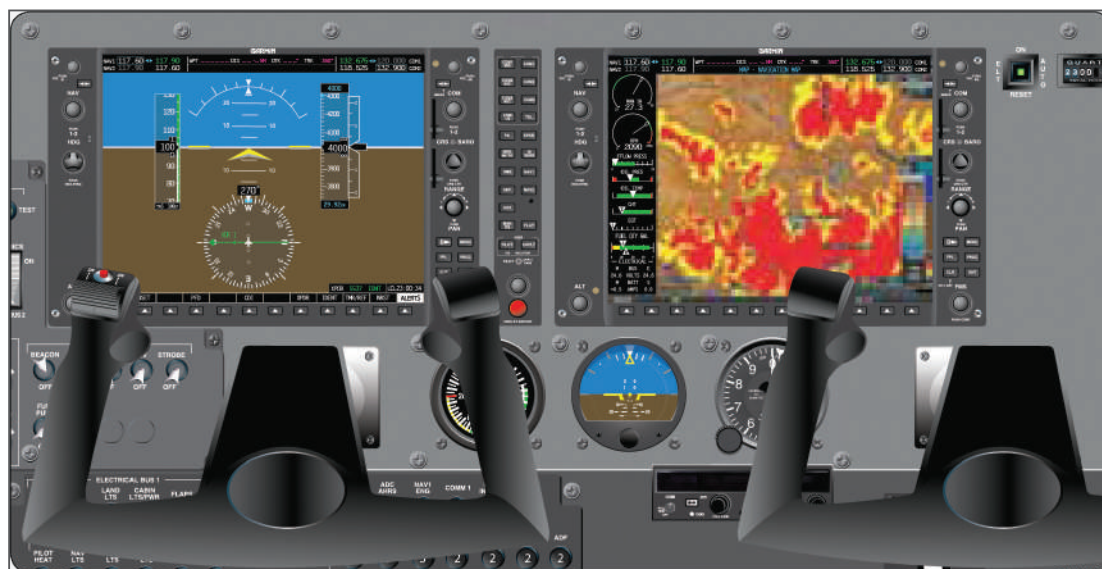
Figura 3 - Painel eletrônico de tela plana da aeronave modelo C-172 Fonte: EUA, 2012. FAA.
