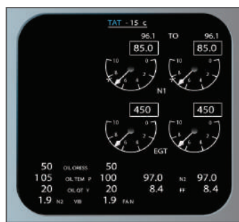
Figura 22.D - Mostrador TAT de cabine - Tela digital completo
