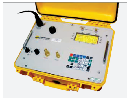
Figura 72.B - Unidade de teste do sistema digital do pitot-estático Fonte: EUA, 2012. FAA.
