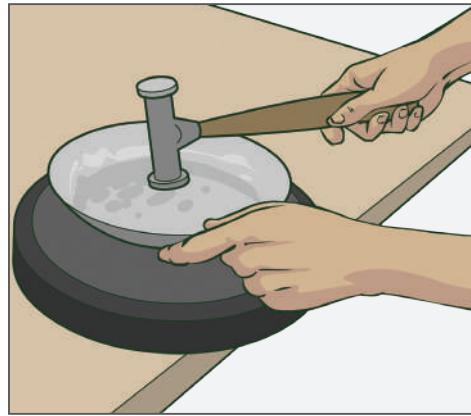
Figura 39.E - Ferramenta de suporte: saco de areia
