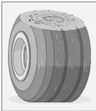
Figura 13 - Exemplo de desgaste do pneu e aparecimentos de lonas
