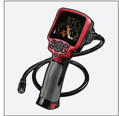
Figura 6 - Equipamento de inspeção buroscópica
