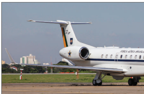
Figura 14.B - Empenagem tipo T Fonte: Agência Força Aérea / © Ten Enilton.
