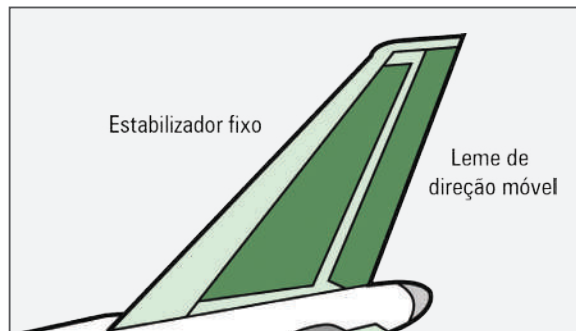
Figura 13 - Leme de direção e estabilizador vertical
