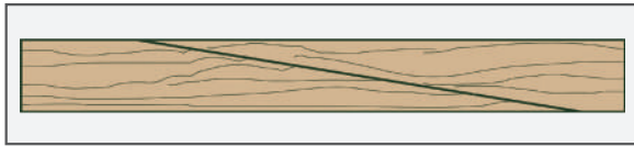
Figura 57.A - Peça corretamente chanfrada
