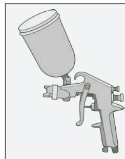
Figura 8.B - Pistola de pintura com alimentação por gravidade
