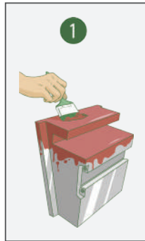
Figura 31.A - Aplicação do líquido penetrante na extensão da peça
