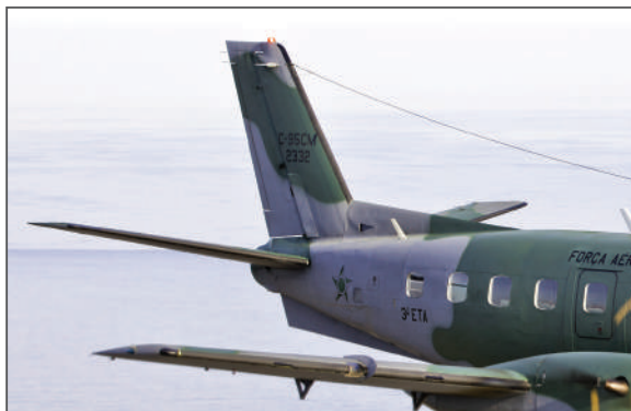
Figura 14.A - Empenagem convencional Fonte: Agência Força Aérea / © Sgt Simo.
