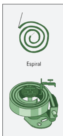
Figura 5.B - Tubo Bourdon em espiral
