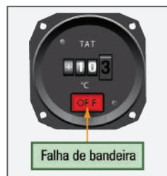
Figura 22.B - Mostrador TAT de cabine - Indicador acionado por servo
