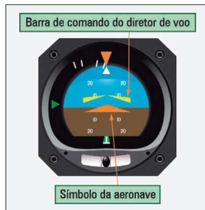
Figura 50.A - Instrumento indicador de atitude mostrando aeronave desnivelada
