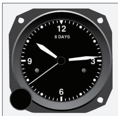
Figura 66 - Relógio mecânico aeronáutico comum de oito dias
