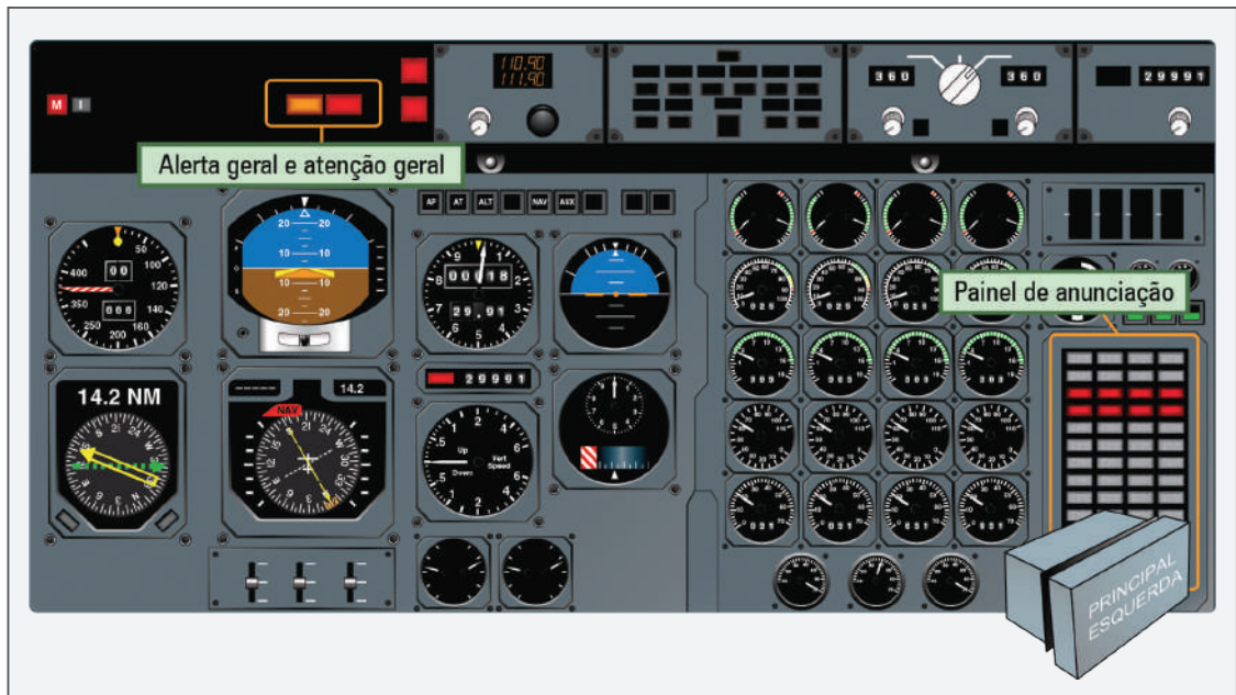
Figura 64 - Painel anunciador centralizado analógico
