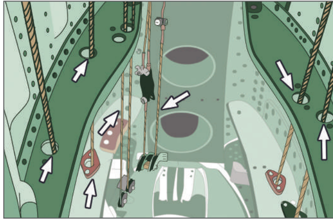
Figura 21 - Exemplo de cabos de comando atravessando os membros estruturais
