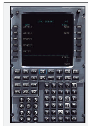
Figura 63 - Unidade de controle (CDU) de um FMS
