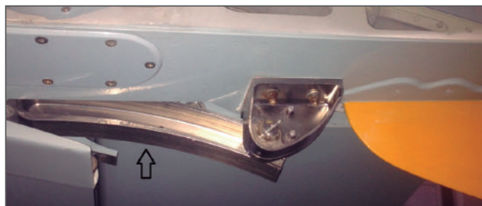
Figura 18 - Exemplo de trilho do flap
