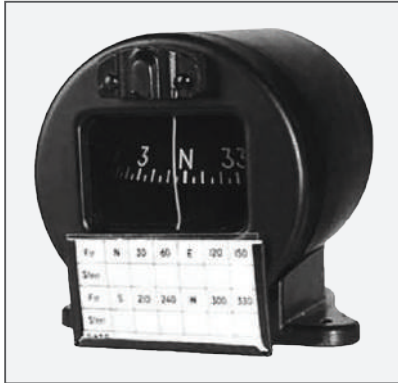
Figura 73 - Bússola magnética com um cartão de correção do desvio em anexo Fonte: EUA, 2012. FAA.
