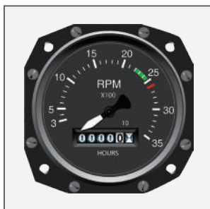
Figura 14.A - Tacômetro para motor a pistão é calibrado em rpm
