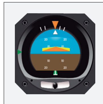
Figura 50.B - Indicador de atitude mostrando aeronave nivelada
