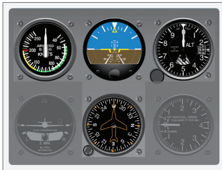
Figura 2 - O arranjo básico em T dos instrumentos de voo analógicos
