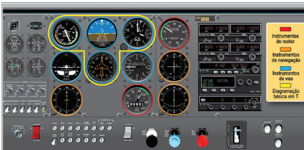
Figura 69 - Instrumentos de voo diretamente à frente do piloto
