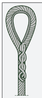
Figura 30.A Terminal trançado apresentando folgas
