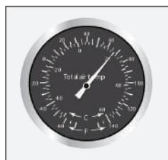
Figura 22.A - Mostrador TAT de cabine - Indicador de plataforma balanceada
