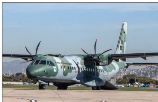
Figura 7 - Aeronave asa cantiléver Fonte: Agência Força Aérea / © Ten Enilton.
