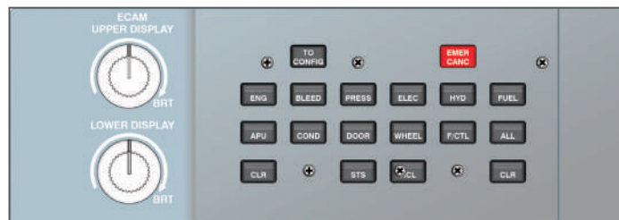
Figura 57 - Painel de controle do display ECAM
