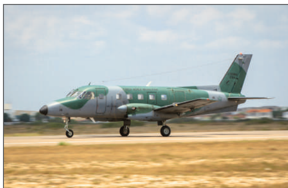
Figura 15.B - Trem de pouso triciclo Fonte: Agência Força Aérea / © Cb Feitosa.
