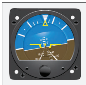
Figura 38.B - Indicador de atitude comum acionado por sucção mostrando a aeronave em uma curva de subida à direita
