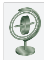
Figura 34.D - Giro livre para rodar nos dois eixos perpendiculares ao eixo de giro
