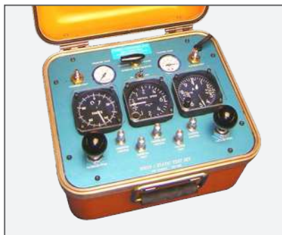
Figura 72.A - Unidade de teste do sistema analógico do pitot-estático Fonte: EUA, 2012. FAA.
