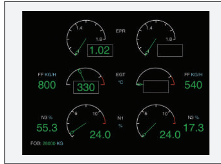
Figura 7.B - Indicação EPR digital e outros parâmetros do motor a turbina em uma tela de exibição digital da cabine de comando
