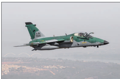
Figura 5 - Aeronave asa média Fonte: Agência Força Aérea / © Sgt Batista.
