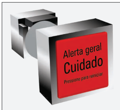
Figura 65 - Interruptor de alerta geral destacado do painel de instrumentos
