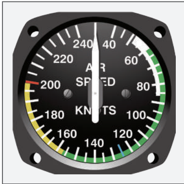
Figura 71 - Indicador de velocidade faz amplo uso das marcações de faixa
