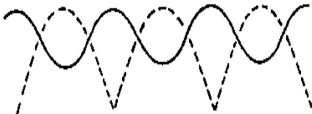
Figura 8-248 Saída de um indutor como filtro de retificador.
