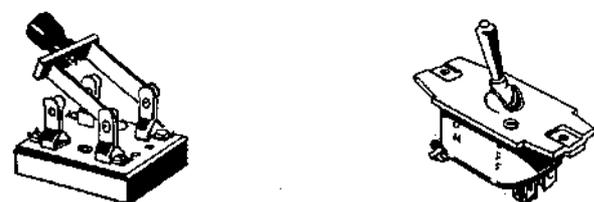
Figura 8-114 Chaves bipolares para circuito simples, do tipo faca e do tipo "toggle".
