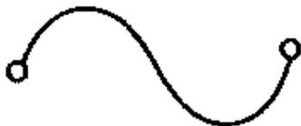
Figura 8-26 Símbolo esquemático de um fusível.
